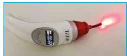
Dispositif permettant de concentrer la puissance d'une LED sur une zone restreinte
